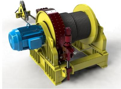
Guincho de elevação com acionamento hidráulico.
