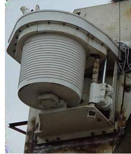
Guincho suspenso de montagem vertical e acionamento hidráulico para operações de lançamento de linhas submarinas.
