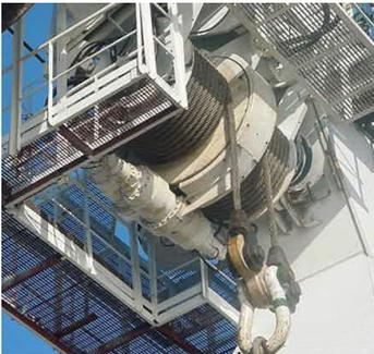
Guincho suspenso com acionamento hidráulico para operações de lançamento de linhas submarinas.
