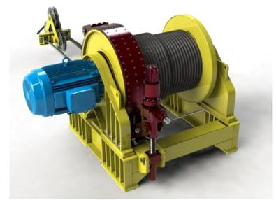
Guinchos de elevação e de arraste com acionamento elétrico, pneumático ou hidráulico e guia cabo para correta distribuição do cabo no tambor. Equipamentos de alto rendimento, com construção robusta, permitindo trações desejadas com segurança e obedecendo a todas as normas vigentes ao local ou tipo de operação em que serão utilizados. Podem ser fornecidos com redutor planetário interno ou externo ao tambor. Totalmente adaptados para ambiente onshore e/ou offshore
