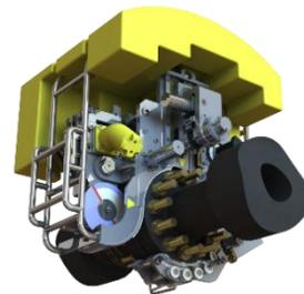
Ferramenta de corte e montagem de estojos de flanges API.
